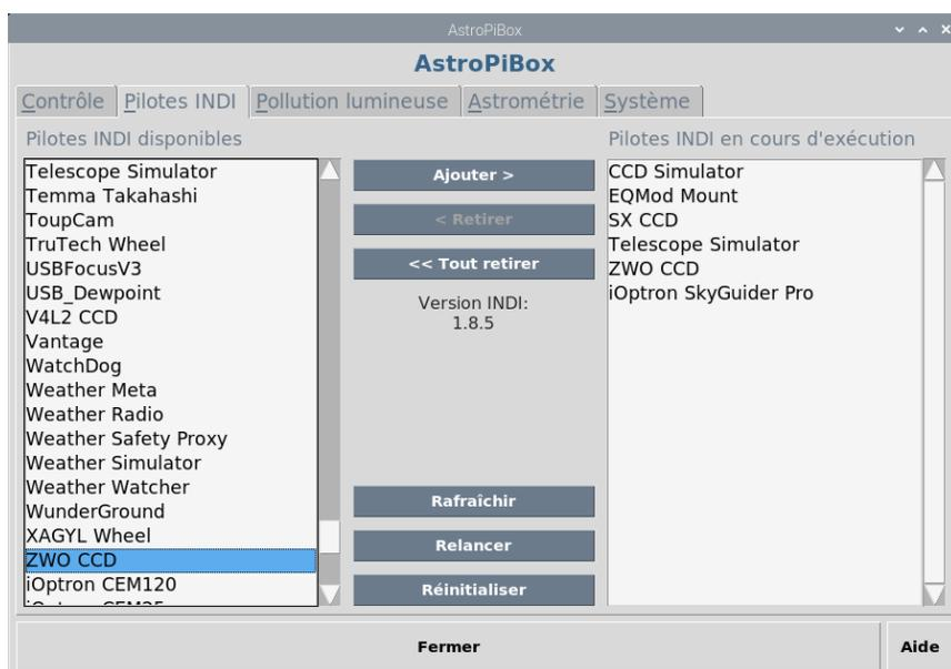
La première chose à faire est de s'assurer que le pilote INDI de la caméra à utiliser (et éventuellement de la monture à contrôler) est bien chargé dans le gestionnaire de pilote d'AstroPiBox (voir la section consacrée au [gestionnaire de pilotes INDI](#)). C'est en effet au travers du pilote INDI que le logiciel CCDciel pourra accéder au dispositif d'acquisition d'images.
