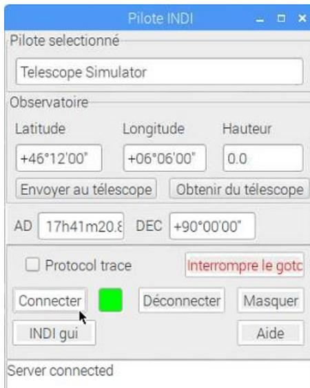
La boîte de dialogue ci-contre s'affiche et il suffit alors de cliquer le bouton *Connecter* pour se connecter à la monture du télescope au travers du pilote INDI.
