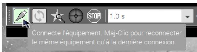
Lors du premier lancement, il est nécessaire d'indiquer à PHD2 quel est le matériel utilisé pour réaliser l'autoguidage, en l'occurrence le type de la caméra et le type de la monture. Pour cela, il faut afficher la fenêtre de connexion des équipements accessible à l'aide du bouton en bas et à gauche de la fenêtre (de couleur verte). Dans la fenêtre qui s'affiche, il faut alors choisir la caméra dans la liste déroulante *Caméra*.
